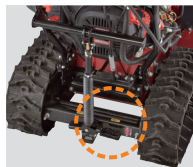
フットペダルでオーガーの高さをラクラク調節。
