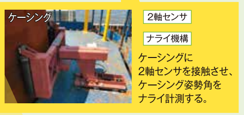
ケーシング 2軸センサ ナライ機構
