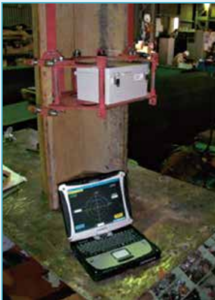
矢板傾斜計設置状況
