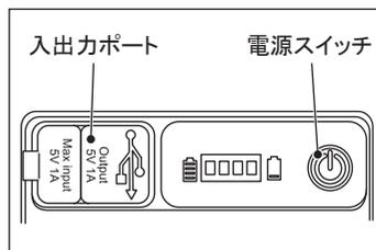
USB 充電を行う場合は、電源スイッチを切り、充電ポートに USB 充電ケーブルの Type-C 側を接続し、USB 充電ケーブルの Type-A コネクタを電力供給元の USB に接続します。接続すると充電を開始します。充電の最大電圧 / 電流値は 5V/1A です。
