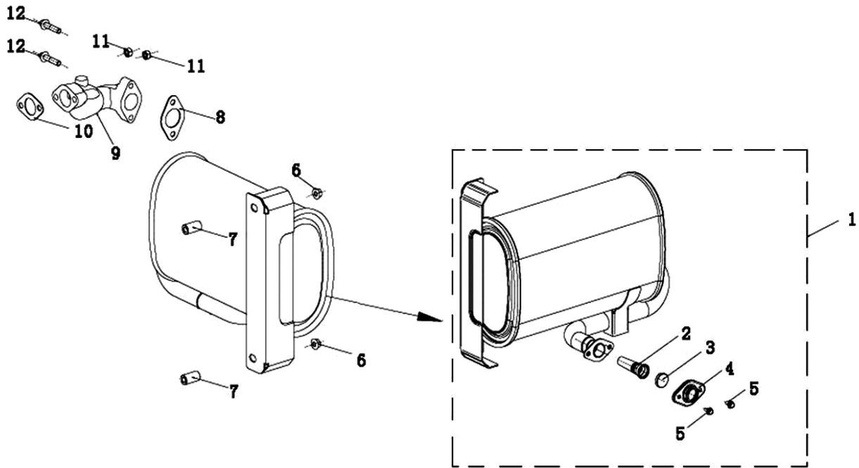
HPG6500iS 消音器 (MUFFLER ASSY)
