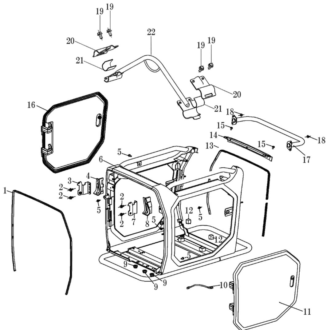
HPG6500iS フレーム (Components of frame)
