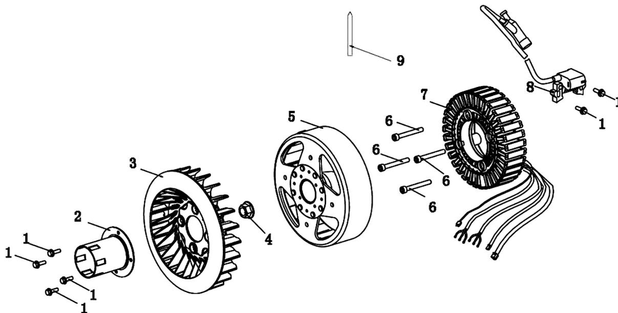
HPG6500iS ローター、ステーター (ROTOR、STATOR)
