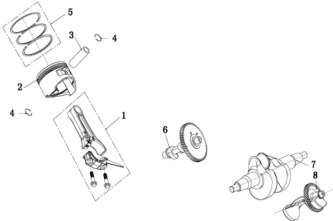
HPG6500iS ピストン/コンロッド (PISTON/ROD ASSY „CONNECTING )
